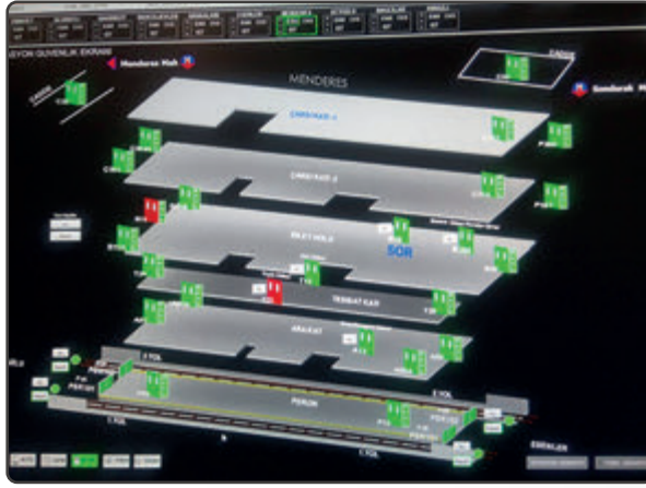
M1 Hattı SCADA Ekran Görüntüsü
